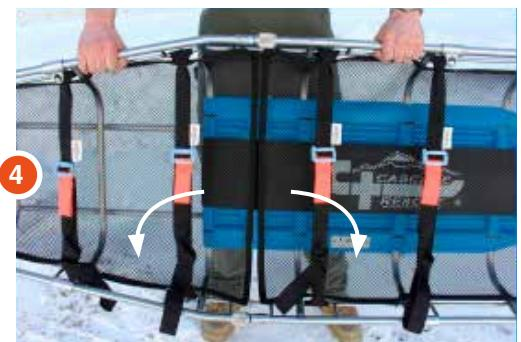
Fixez les raccords FastLock en les vissant ensemble, comme vous le feriez avec un mousqueton à bague vissée
