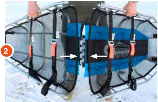
Heben Sie ein Teil der Korbtrage mit leichtem Druck gerade nach oben, während Sie das andere Teil leicht nach unten drücken. Dadurch werden die Zapfen der Zwischenplatte in Eingriff gebracht (3). Drehen Sie die Enden der Korbtrage von sich selbst weg, bis die Korbtrage relativ flach ist und die FastLock-Verbindungsstücke aufeinander ausgerichtet sind (4).
